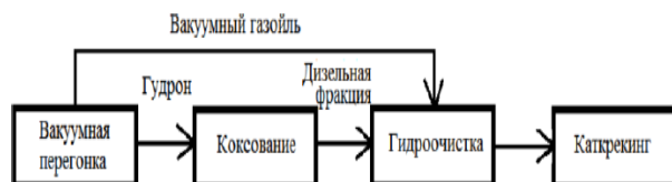
Рисунок 1 - Комбинация замедленного коксования с каталитическими процессами
